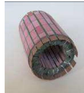
Рис.5 Общий вид трубчатой термобатареи.
