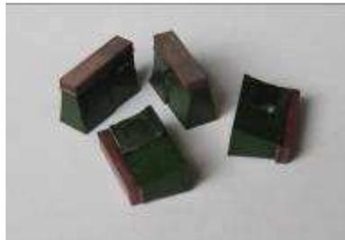
Рис.3 Общий вид терморективно паяных термоэлементов из трапецидальных ветвей п- и р-типа.
