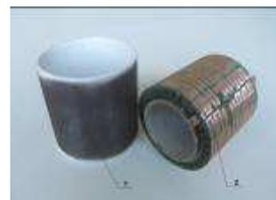
Рис.5 Общий вид трубчатой термобатареи (2)
