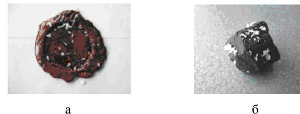
Рис.4. Притяжение пенопластовой стружки к поверхности «заряженных» сургучной печати (а) и кристалла шерла (б).
