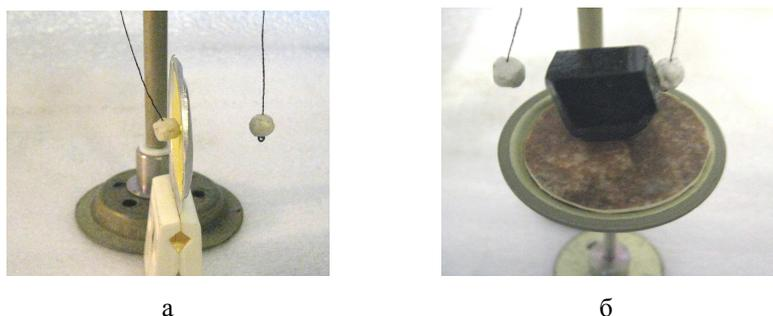
Рис.5. Опыты с отрицательно заряженными пенопластовыми шариками, подтверждающие полярность системы «плавленная сера- изложница» и «заряженного» кристалла турмалина (шерла) после нагрева [7, 8].
