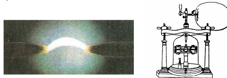
Рис. 1. Электрическая дуга Петрова (а) и его установка трения (б) [2]
