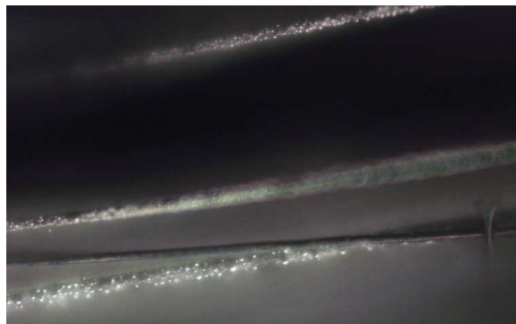
Рис. 2 Глобулы висмута на поверхности углеродного волокна. Толщина волокна 20 мкм.
