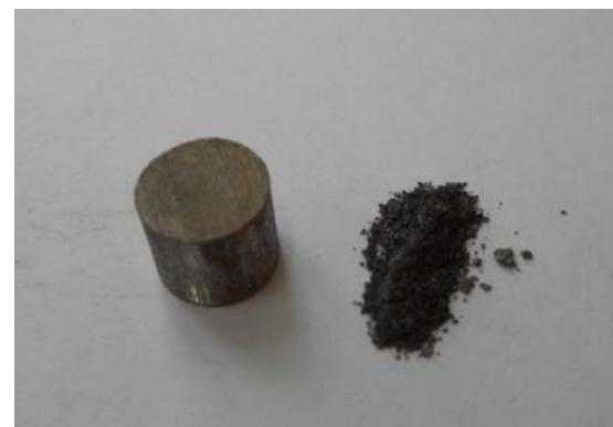
Рис.1. Фрагмент выращенного кристалла \text{Bi}_{0.5}\text{Sb}_{1.5}\text{Te}_3 и приготовленная из него шихта.
