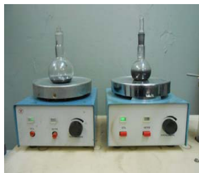
Рис.3. Магнитные мешалки с колбами, в которых проводилась дезинтеграция исходной шихты \text{Bi}_{0.5}\text{Sb}_{1.5}\text{Te}_3
