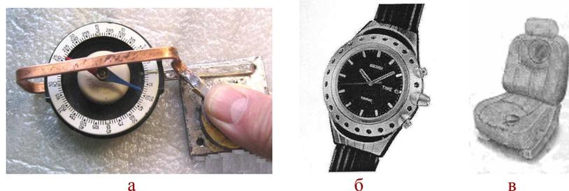
Рис.5. а - Короткозамкнутая термопара Вi – Сu для получения магнитных полей за счет тепла тела человека. [3] .б – часы с термоэлектрическим источником питания, в – автомобильное кресло с термоэлектрическим кондиционером [7].
