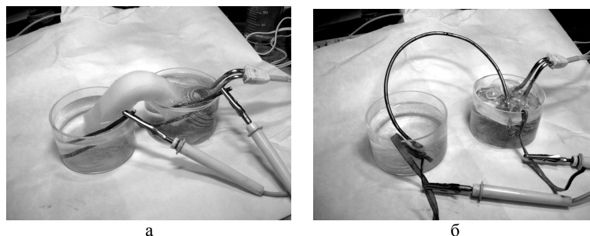
Рис.3. Воспроизведение опыта Вольты с лягушкой и железной проволокой. а – схема измерения термо - э.д.с. гальванического элемента Fe( T= 296 К) /электродит (вода)/ Fe ( T= 373 К) ( \alpha= 1,5 мВ/ К); б – схема измерения термо-э.д.с. неоднородно нагретой железной проволоки относительно свинца ( \Delta T= 296- 373 К) ( \alpha_{Fe}= 12, 9 мкВ/ К) [9].
