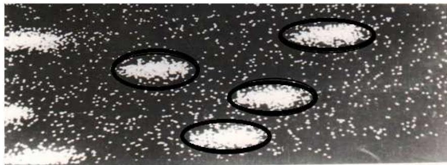
Рис.5. Рентгеновское изображение ориентированной эвтектики системы  $\text{PbTe-NiSb}$ , полученной на электронном микроскопе JSM- 50A продольный шлиф, изображения в лучах  $\text{Sbx}$  2000
