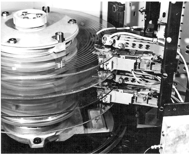
Рис. 4. Лазерный скоростной накопитель цифровых данных на пакете из 4-х дисков.
