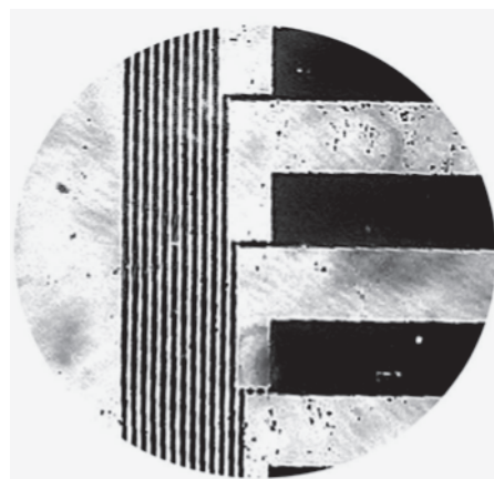
Рис. 7. Хромовые ламели шириной 1,3 мкм на стеклянной подложке, полученные двухмасочным методом по технологии проекционной голографической фотолитографии.
