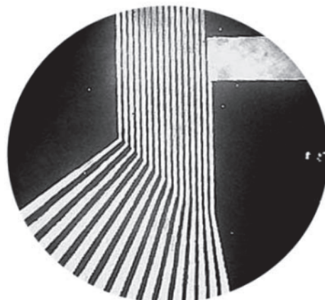
Рис. 6. Хромовые ламели, полученные методом проекционной голографической фотолитографии с помощью маски из ХСП.
