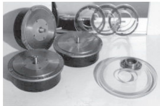
Рис. 3. Фотография радиальных дисков РГДР и голографических преобразователей угловых перемещений УПГ.
