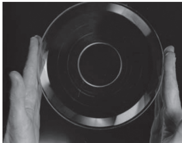
Рис. 5. Фотография радиального голографического диска со средним диаметром штриховой дорожки F = 180 мм и числом штрихов N = 518\,400 штр./ 2\pi .
