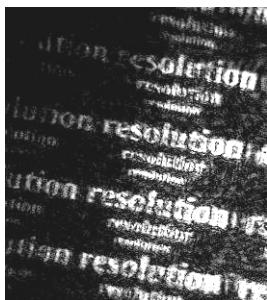
Рис. 8. Изображение, восстановленное с помощью обратного преобразования Френеля.
