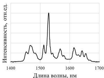
Рис. 2. Спектр люминесценции комбинированного покрытия, содержащего эрбий, \lambda_{\text{возб}} = 532 нм
