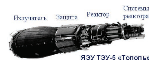
ЯЭУ ТЭУ-5 «Тополь» Рис. 1. Термоэмиссионная ЯЭУ «Тополь» (1987 г.)
