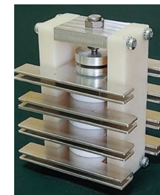
Рис. 2. Сборка динисторов Ø24 мм, включаемых ударно-ионизационным фронтом, для формирования мощных наносекундных импульсов амплитудой 12 кВ, 3 кА с частотой повторения до 500 Гц
