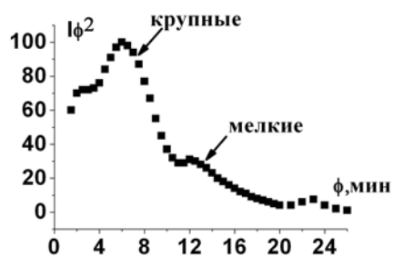
Рис. 4. Функция Порода для аморфного сплава \text{Fe}_{58}\text{Ni}_{20}\text{Si}_{19}\text{B}_{13}
