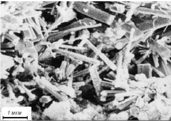
Рис. 3. Характерная структура микрокристаллической части силикатной керамики.
