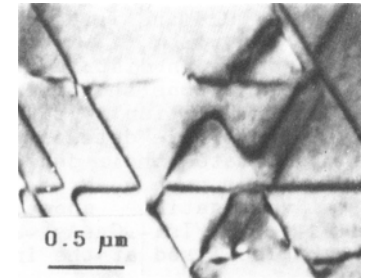
Рис. 3 Электронно-микроскопические изображения дислокационных сеток в ДГС на первой от подложки ГР.
