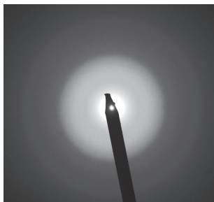
Рис. 1: Картина дифракции электронов ТЭМ пленок из наночастиц Ni
