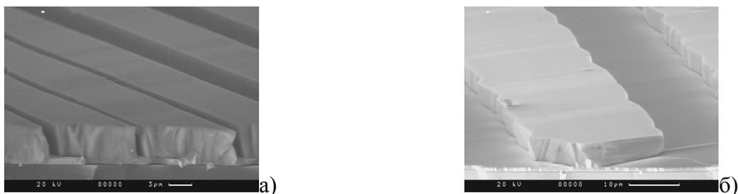
Рис. 2 РЭМ изображения полосков, синтезированных на  $a$ -GaN а) ориентация полоска вдоль  $m$ -направления б) ориентация полоска под углом  $7.5^\circ$  к  $m$ -направлению.
