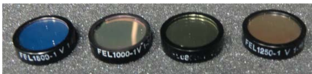
Рис. 2.18: Длинноволновые фильтры, использованные при оптических измерениях.
