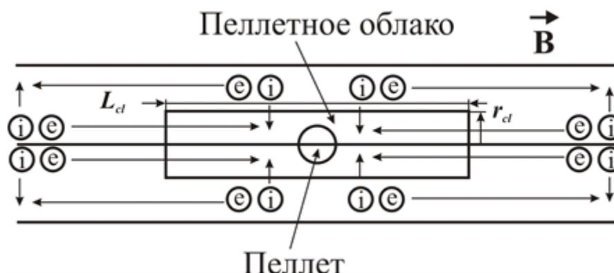
Рисунок 3.10 – Схема токов в пеллетном плазменном облаке и окружающей плазме, которая может привести к заметному снижению перепада потенциала между ними, вычисленного в рамках одномерной модели [106]
