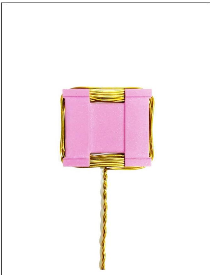
Рисунок 17. фотография зонда тороидального массива
