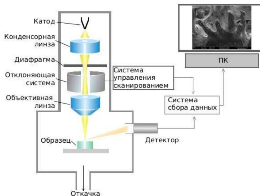
Рисунок 19 - Принципиальная схема сканирующего электронного микроскопа.
