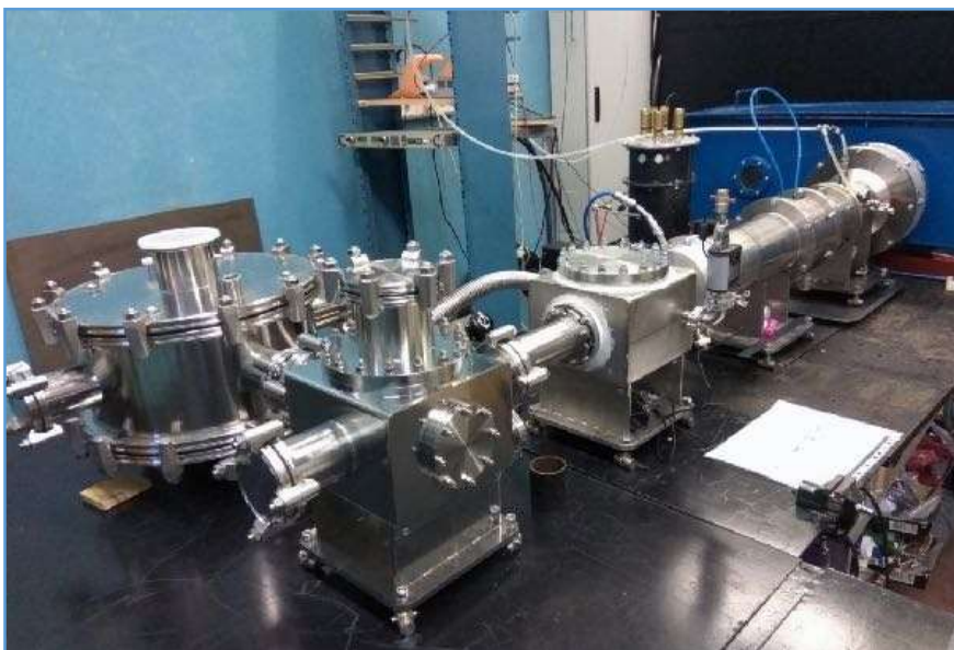
Рисунок 1.13. Установка «Экстрим-М», прототип настольного источника на 46.9 нм на капиллярном разряде в Физико-Техническом институте им. А.Ф. Иоффе.
