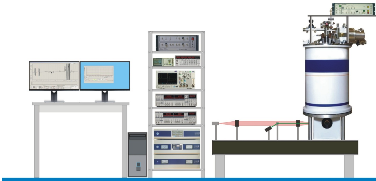
Рис. 2.1. Внешний вид высокочастотного ЭПР/ОДМР спектрометра.
