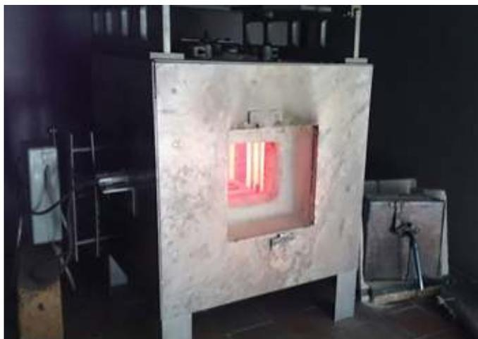
Рисунок 2.1 — Высокотемпературная печь для синтеза монокристаллов
