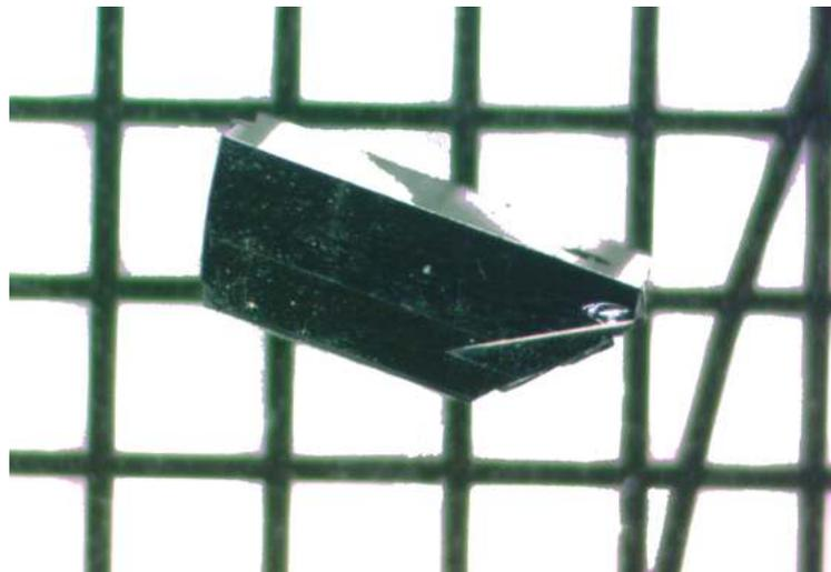
Рисунок 3.4 — Фотографии монокристаллических образцов  $\text{Cu}_2\text{FeVO}_5$ , полученные при помощи оптического микроскопа. Размеры одной клетки  $1 \times 1 \text{ мм}$ .
