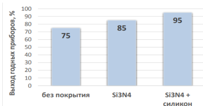
Рис. 3.26. Влияние пассивации и герметизации меза-структуры на деградацию параметров ФЭП при воздействии факторов окружающей среды.
