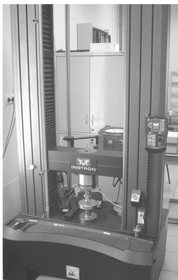
Рис.1. Универсальная испытательная машина Instron 5982 с установленными для проведения испытаний опорными плитами и образцом.
